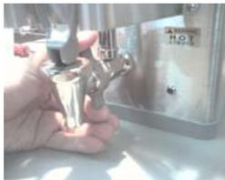
26. Coloque la válvula de servido en el termo y ajuste con la contratuerca girándola en sentido contrario a las manecillas del reloj.
