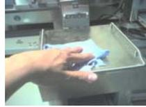
6. Desconecte eléctricamente y limpie la superficie de la base para el termo con un trapo húmedo solamente, si hay acumulación de grasa utilice un detergente líquido no abrasivo y talle con una franela suave, seque bien para evitar manchas.
