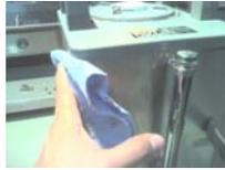
5. Limpie la superficie del termo con un trapo húmedo solamente, si hay acumulación de grasa utilice un detergente líquido no abrasivo y talle con una franela suave, seque bien para evitar manchas.
