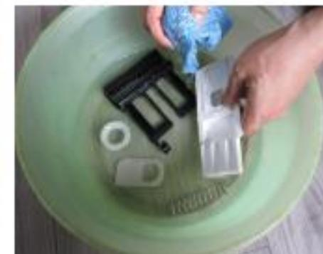
12. 把所有部件浸入温水中,在温水中加入清洗剂,擦拭所有部件,如有需要,用小毛刷刷有凹槽的地方. 料缸盖子不能浸泡
