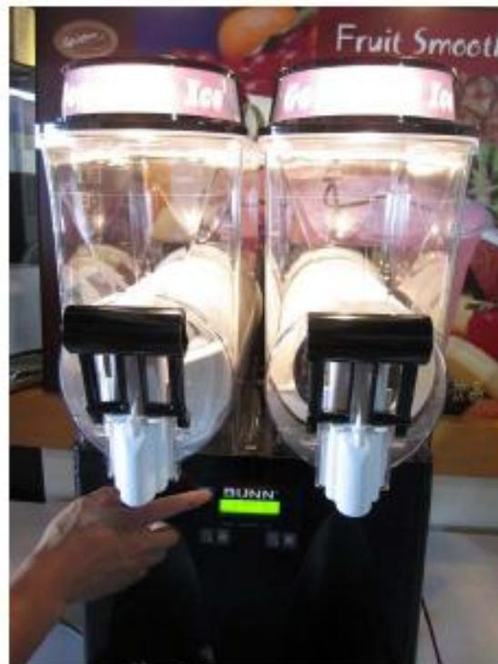
3. 关闭旋转叶,并关闭电源
