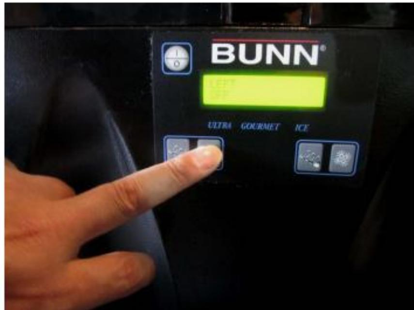
1.关闭左右两边制冰键,将旋转键调到 ON
