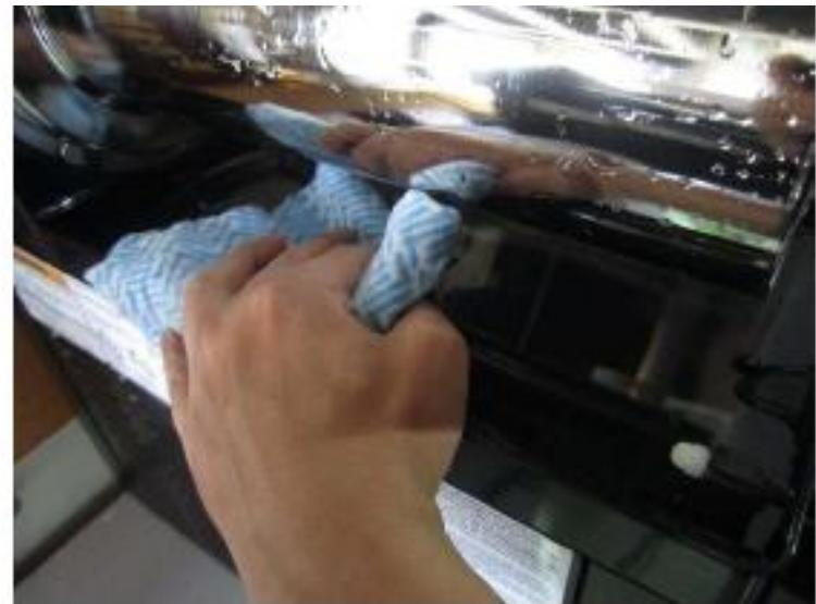
9.用温水擦洗制冷鼓和下面的水槽,并擦拭干净
