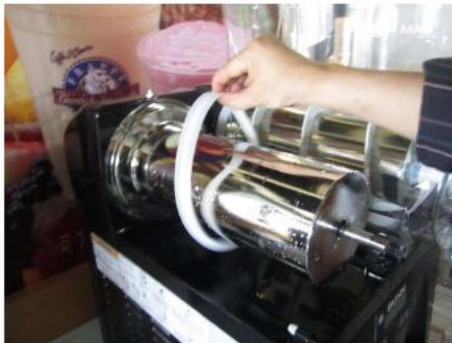
8.将制冷鼓的密封圈从制冷鼓的后部取出
