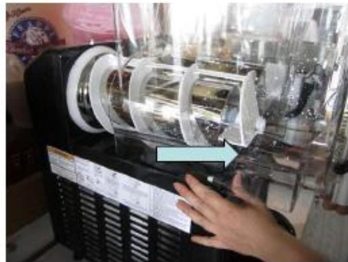
5. 把料缸的锁扣压下,微微抬起料缸,将料缸往图示方向拉出
