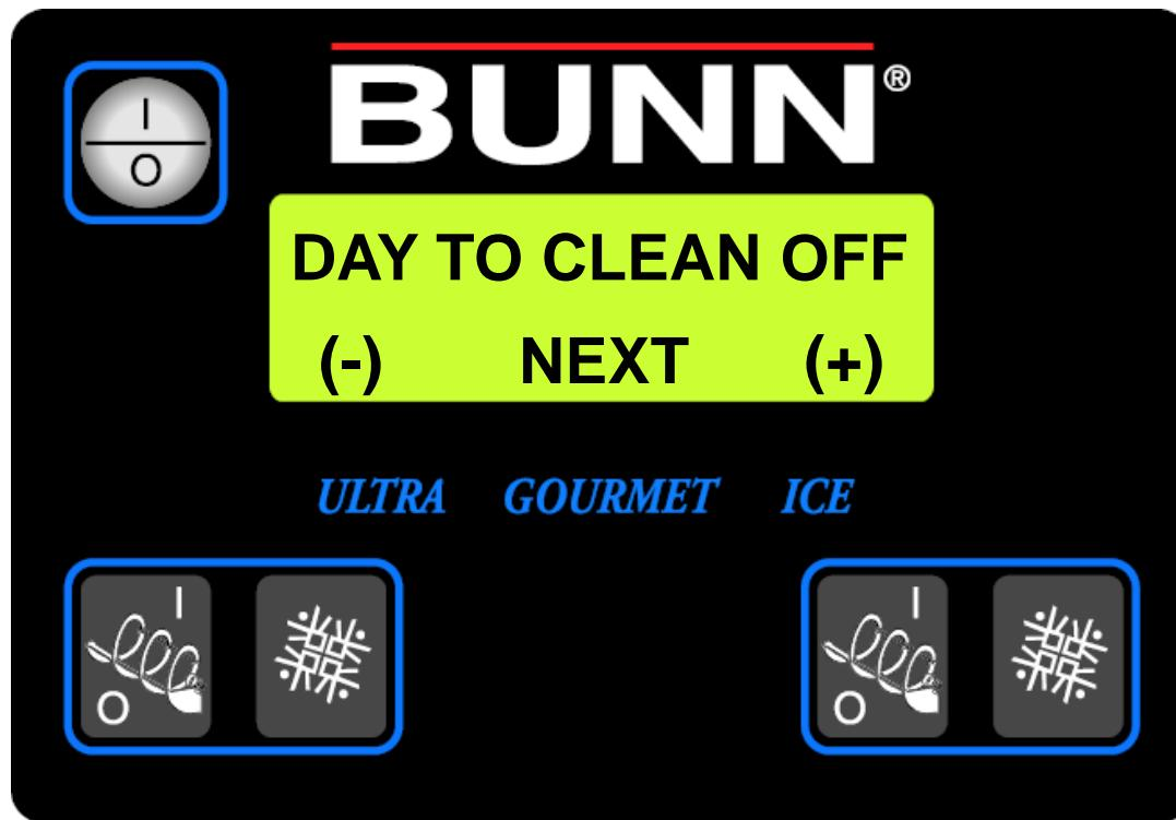
“**DAYS TO CLEAN**” 间隔时间从1到14天，一旦激活，你可以选择“**message only**信息提醒” or “**lockout**冷冻停止” 如果选者冷冻停止，机器将处于“**CHILL**”状态，直到你一步一步完成清洗。(至少1分钟) &冷却鼓温度要在50° F 以上，才行.
